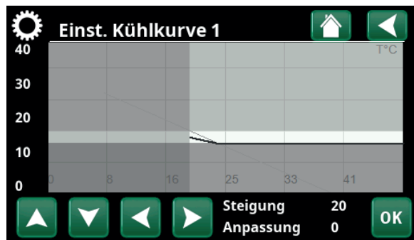
Menü „Fachmann/Einstellungen/Kühlung/Kühlkurve/Einst. Kühlkurve“.
