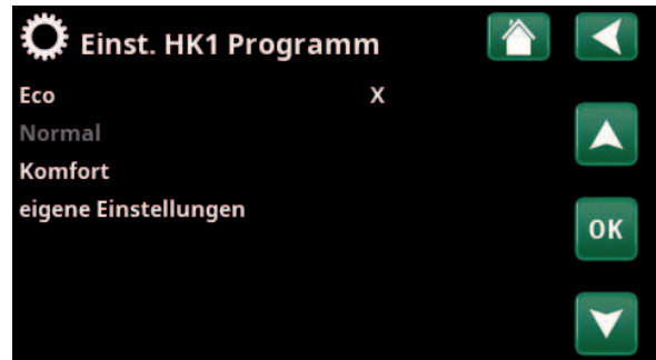
Menü „Fachmann/Einstellungen/Heizkreis/Heizkreis 1/Programm“.
