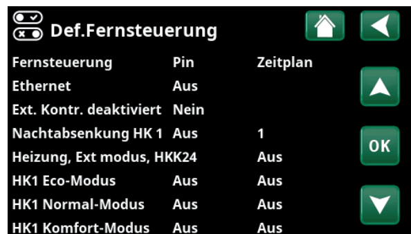
Ausschnitt aus dem Menü „Fachmann/Definieren/Fernsteuerung“
