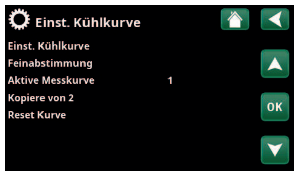
Menü „Fachmann/Einstellungen/Kühlung/Kühlkurve/Einst. Kühlkurve“.
