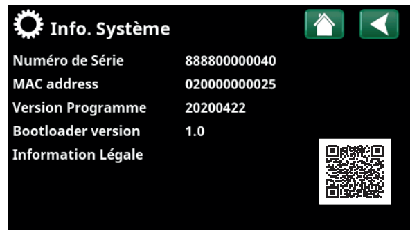
Menu : «Installateur/Info. Système» Pour accéder à ce menu, cliquez sur le bouton «i» en bas à droite de l'écran du menu «Installateur».
