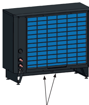
Bac à condensats et drain de condensats.
