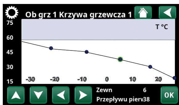
Menü „Instalator\Ustawienia\Obieg grzewczy\Obieg grzewczy 1/ Krzywa grzewcza/Optymalne ustawienie”.
