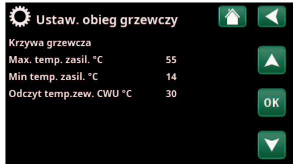
Menu: „Instalator/Ustawienia/Obieg grzewczy” do zdalnego sterowania zewnętrznym zbiornikiem CWU.
