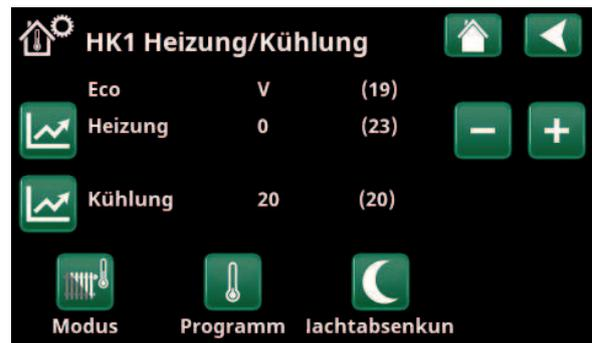
Im Menü sind die Programme „Eco“ und „Urlaubsmodus“ (V) für Heizkreis 1 aktiv. In diesem Beispiel ist für beide Programme „Eco“ und „Urlaubsmodus“ eine Absenkung des Sollwerts (23,5 °C) um 2 °C eingestellt. Dies bedeutet, dass der effektive Sollwert = 23,5 - 2 - 2 °C = 19,5 °C beträgt.
