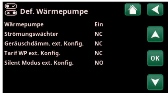
Menü: „Fachmann/Definieren/Wärmepumpe“. Normalmodus für das externe Steuersignal (standardmäßig offen (NO)/standardmäßig geschlossen (NC)).
