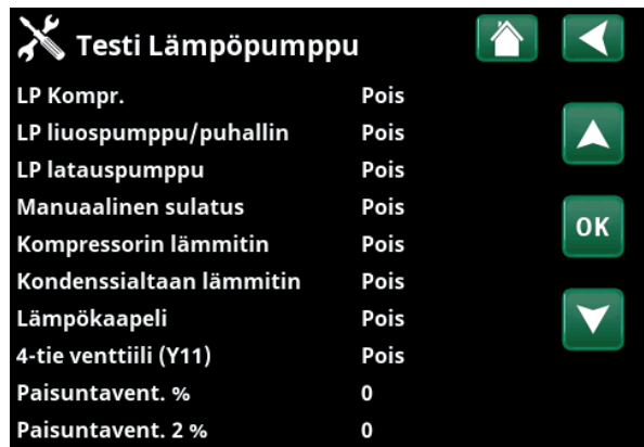
Valikko "Edistyneempi / Huolto / Toimintatesti / Lämpöpumppu".
