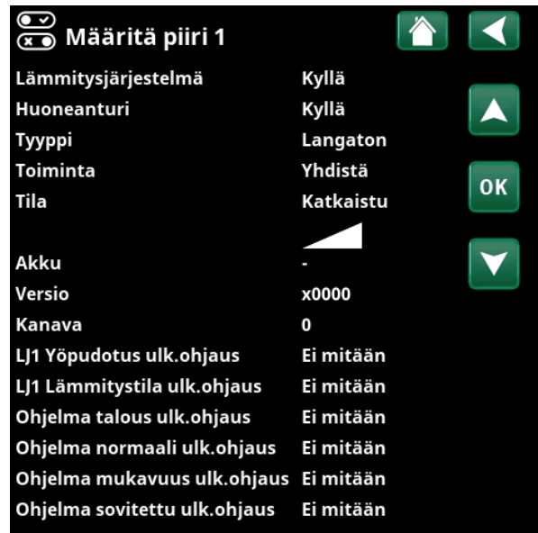
Valikko "Edistyneempi/Määrittele/Lämmitysjärjestelmä/LJ1". Langaton huoneanturi on valittu.
