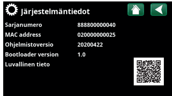
Valikko "Edistyneempi / Järjestelmätiedot". Siirry tähän valikkoon napsauttamalla "i"-painiketta valikon "Edistyneempi" oikeassa alakulmassa.
