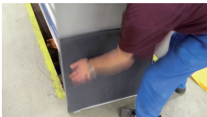
5. Tryck till så att isoleringen fastnar
