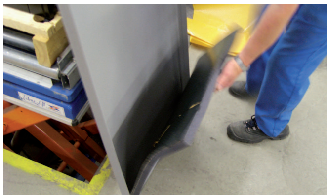
4. Montering av isolering på frontluckan.
