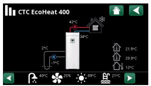
Page de menu principale pour «État Installation». Lorsque les pompes sont en fonctionnement, les icônes de pompe tournent sur l'écran. N. B.: Les valeurs de fonctionnement affichées dans les captures d'écran du menu ne sont que des exemples.
