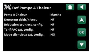
Menu : «Installateur/Définir/Pompe A chaleur». Un mode pour le signal de commande externe (Normalement ouvert (NO)/Normalement fermé (NF)). Exemple de «SmartGrid Prix bas» pour le chauffage piscine.
