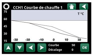
$\label{lem:menu} Menu \ {\it wInstallateur/R\'eglages/Circ Chauffage/Circ Chauffage 1/ Courbe de chauffe».}$
