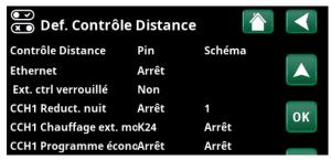
Menu : «Installateur / Définir / Contrôle Distance». La fonction de contrôle à distance «Chauffage, Ext Mode, Circ 1» est affectée au bornier de connexion «K24».
