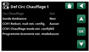
Menu « Installateur/Définir/Circ Chauffage/Circ Chauffage 1 ».
