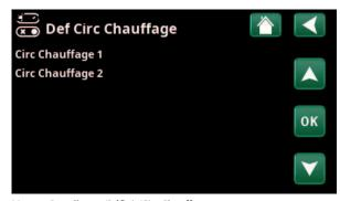
Menu : «Installateur/Définir/Circ Chauffage». Sélectionnez un circuit de chauffage et appuyez sur «OK» pour accéder aux réglages.
