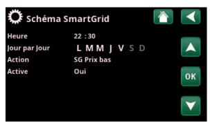
La fonction SmartGrid «SG Prix bas» est programmée en semaine de 22h30 à 06h00. Accédez au menu en sélectionnant «Schéma SmartGrid» dans le menu «Installateur/Réglages».
