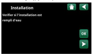
3. Vérifiez si l'installation est remplie d'eau. Confirmez en appuyant sur «OK» et la touche fléchée «droite».
