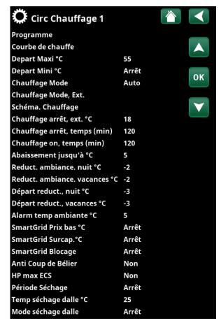
Menu «Installateur/Réglages/Circ Chauffage/Circ Chauffage 1».
