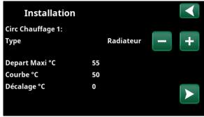
8. Indiquez si le circuit de chauffage 1 s'applique aux radiateurs ou au plancher chauffant. Passez de «Radiateur» à «Plancher chauffant» à l'aide des boutons «+» et «-». Confirmez avec la touche fléchée «droite»
