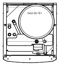
La pré-pression dans le vase d'expansion est calculée en fonction de la hauteur (H) entre le radiateur positionné le plus haut et le vase d'expansion. La pré-pression doit être vérifiée/réglée avant que le système soit rempli d'eau. La pression du système doit être réglée sur une valeur de 0,3 bar supérieure à la pré-pression dans le vase d'expansion. Par exemple, une pré-pression de 1,0 bar (5 mvp) signifie une différence de hauteur maximale permise de 10 m.
