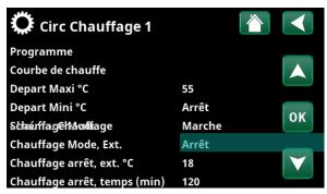
Menu : «Installateur/Réglages/Circ Chauffage/Circ Chauffage 1» Le mode de contrôle à distance «Arrêt» devient actif lorsque le bornier de connexion K24 se ferme.
