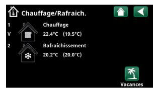
Cliquez sur le circuit de chauffage 1 ou 2 pour accéder au menu du circuit correspondant. Dans ce menu, vous pouvez activer le « Mode Vacances » pour les circuits de chauffage.
