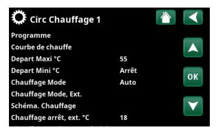
Menu : «Installateur/Réglages/Circ Chauffage». Le mode de contrôle à distance du circuit de chauffage est défini sur la barre de menus «Chauffage, Ext Mode». Accédez au programme hebdomadaire à partir de la barre de menus «Prog. Chauffage Hebdo».
