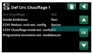
Menu : «Installateur/Définir/Circ Chauffage/Circ Chauffage 1». Le mode normal du signal de contrôle à distance est défini sur la ligne «Chauffage, Ext Mode, Circ 1».
