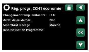
Menu «Installateur/Réglages/Circ Chauffage/Circ Chauffage 1/ Programme/Économie».
