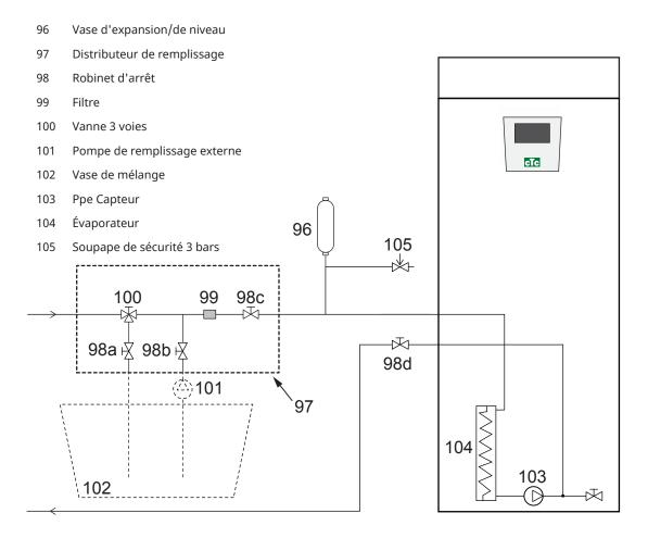
Le diagramme montre la connexion principale pour le circuit d'eau glycolée. L'équipement de remplissage est représenté par les sections en pointillés. N. B.: Les tuyaux du collecteur doivent comporter un dispositif de purge dans la mesure où des poches d'air peuvent se former. Vérifiez toujours le filtre (99) lors du remplissage et lors de la purge du circuit d'eau glycolée.
