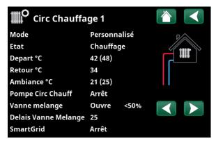
Le menu affiche les données de fonctionnement détaillées du circuit de chauffage sélectionné. Cliquez sur les flèches ou faites glisser latéralement pour afficher les circuits de chauffage définis.
