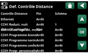
Menu : «Installateur/Définir/Contrôle Distance». La fonction «CCH1 Reduct. nuit» est assignée au schéma n° 1.
