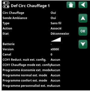
Menu : «Installateur/Définir/Circ Chauffage/Circ Chauffage 1». Sonde d'ambiance sans fil sélectionnée.
