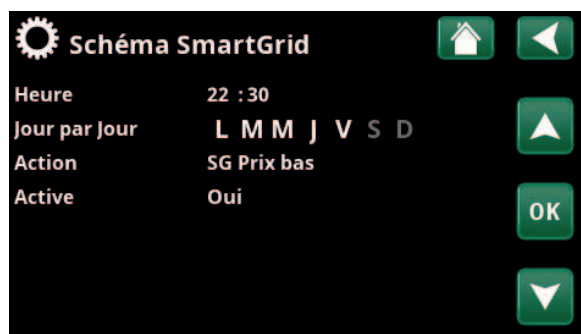
La fonction SmartGrid «SG Prix bas» est programmée en semaine de 22h30 à 06h00. Accédez au menu en sélectionnant «Schéma SmartGrid» dans le menu «Installateur/Réglages».
